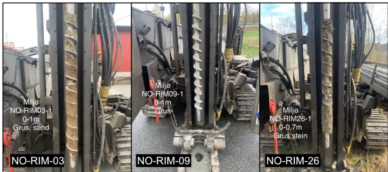
Figur 3-4: Eksempel på prøver av toppmasser (0-1 m) tatt med naverbor.
