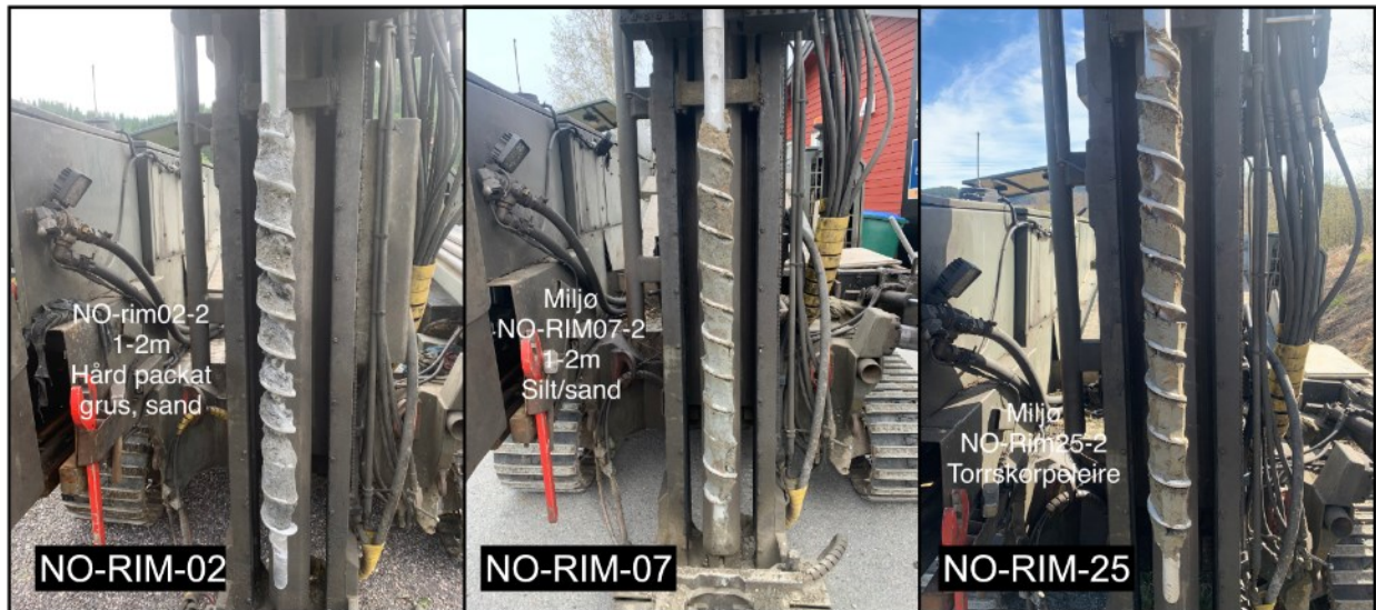
Figur 3-3: Eksempel på prøver av bunnmasser (1-2 m) tatt med naverbor.
